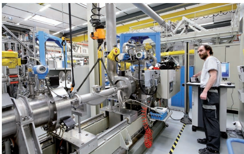
Wzorcowanie przepływomierza w punkcie stacjonarym
